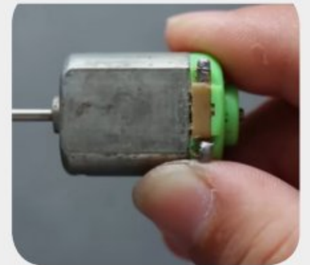
مولّد كهربائي (المحرك الموجود في ألعاب الأطفال الحركيّة)
